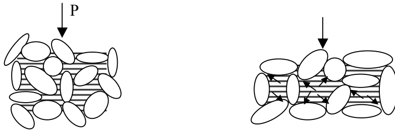
Şekil 9: Doymuş zeminde ilave boşluk suyu basıncı kavramı
